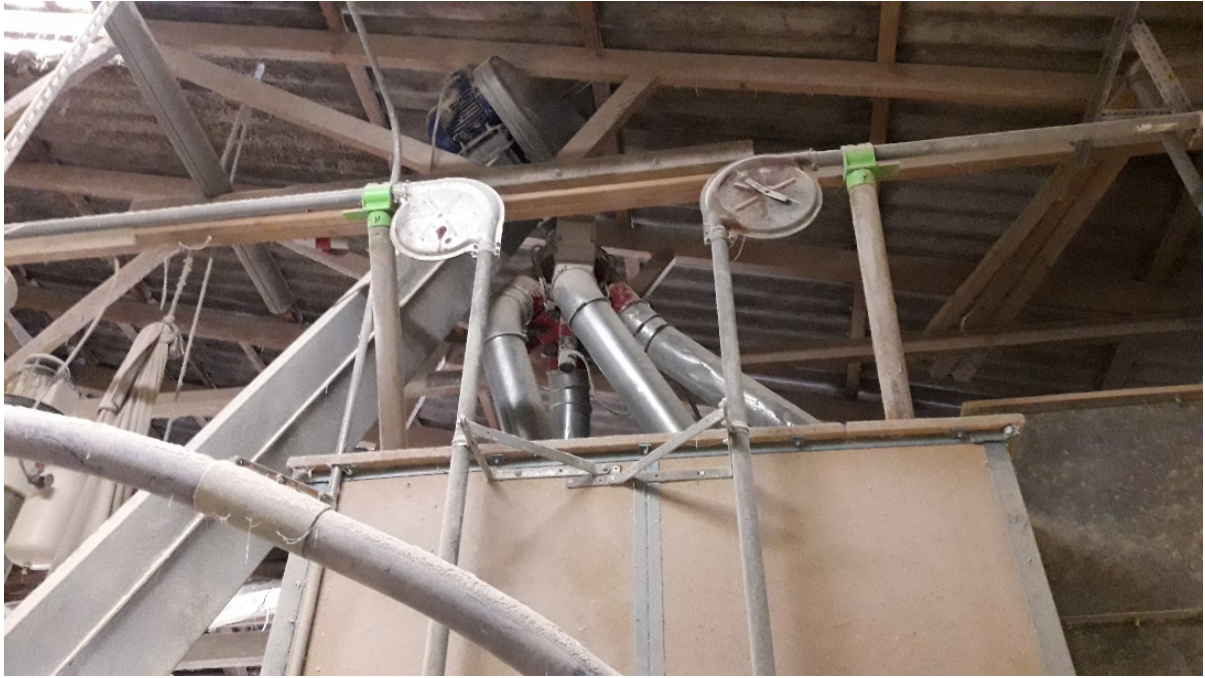
Billede 2. Foderanlæg til tømmevejsregistrering. Elevator tømmer foderblanderen, og fodercomputeren styrer spjældet i fordeleren (rød). Derved registreres i hvilken silo foderet tildeles. Hver sektion har sin egen færdigvaresilo med monteret sensor, som aktiverer foderblanderen, når siloen er ved at være tom.
